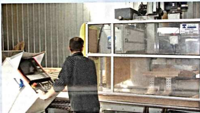
Centre d'usinage à commande numérique.
